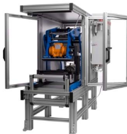
Obr. 7 a 8 Čtyřbodové zkušební zařízení se zařízením pro přípravu vzorků „segmentový zhutňovač“
