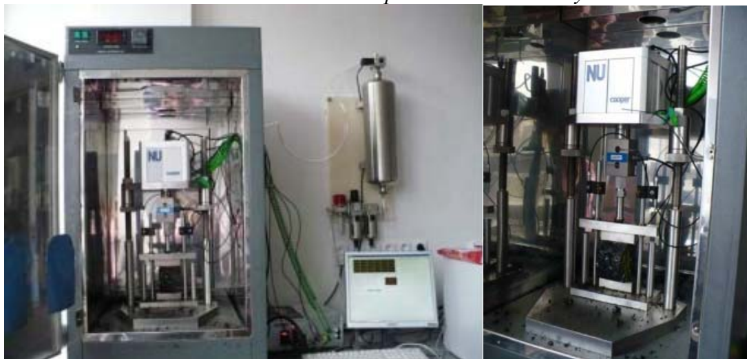
Obr. 13 a 14 Zkušební zařízení se vzorkem pro stanovení únavových vlastností směsí
