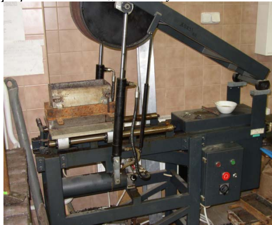
Obr. 2 a 3 Malé zkušební zařízení s zařízením pro přípravu vzorků „lamelový zhutňovač“
