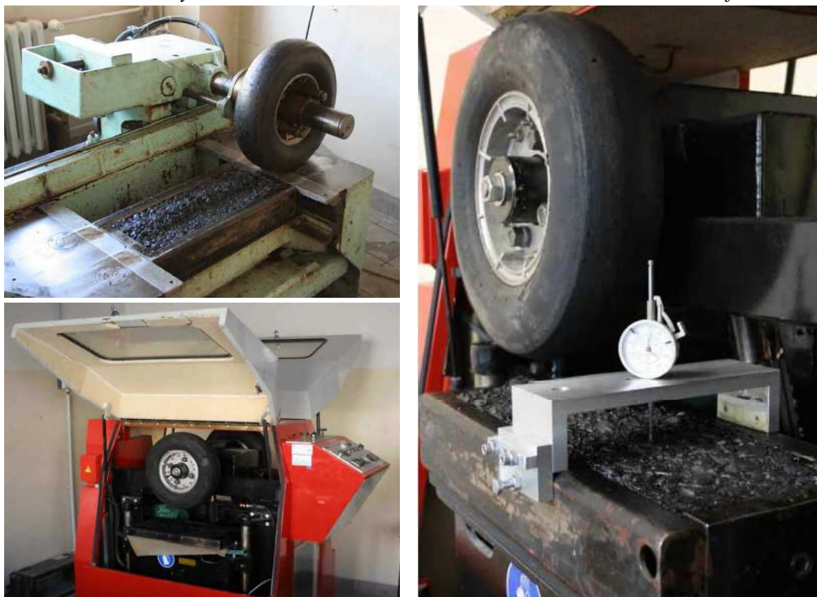
Obr. 1 Pneumatikový zhutňovač desek, velké zkušební zařízení a vlastní měření deformace
