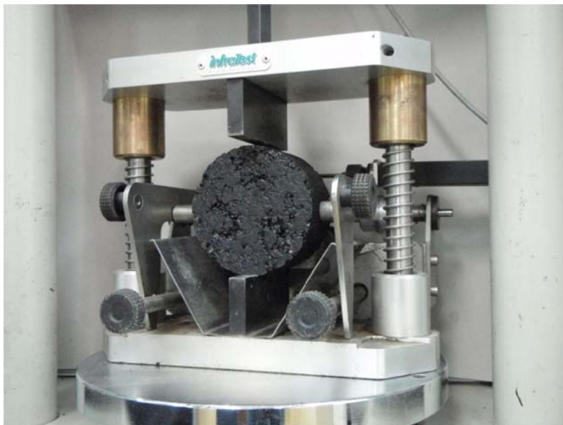
Rys. 6.2. Próбка przed badaniem wytrzymałości na pośrednie rozciąganie
