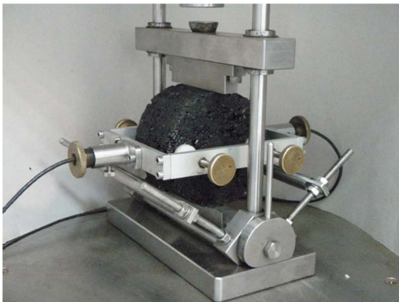
Rys. 6.1. Schemat zamocowania próbki przed badaniem modułu w schemacie IT-CY
