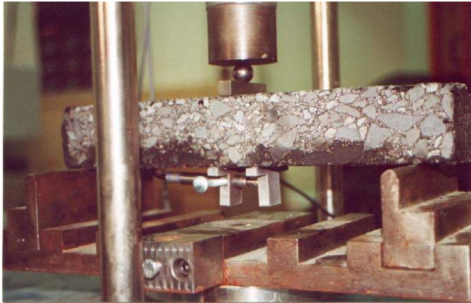
Rysunek 9.2. Próbką podczas badania odporności na spękania niskotemperaturowe
