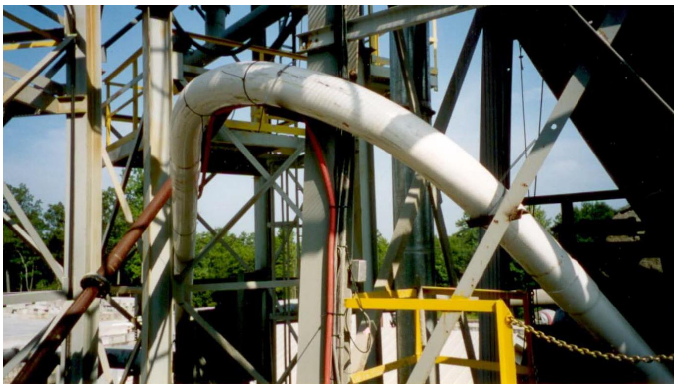
Pozvolný oblouk umožňuje plynulou dopravu vláken.
